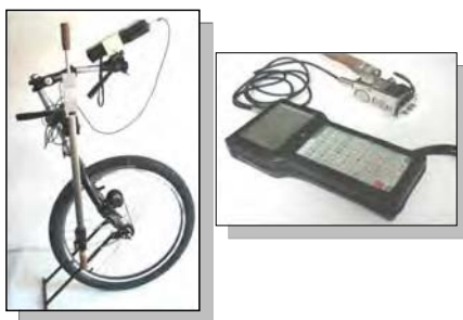
Obr. 2.1 – Snímání magnetického pole nad potrubím v zemi v ose potrubí
