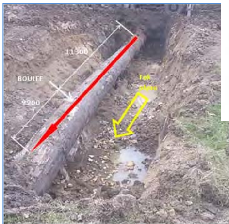
Obr. 2.1 – Snímání magnetického pole nad potrubím v zemi v ose potrubí
