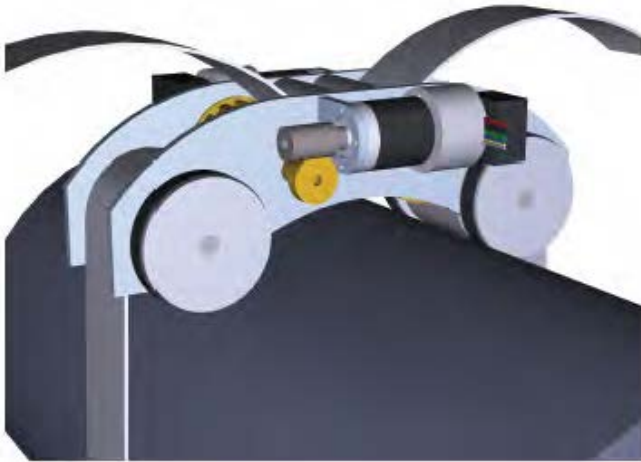
Obr. 1 Návrh obvodového pojezdu manipulátoru pro zkoušení svarů potrubí
