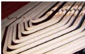
Obr. 14 Vnitřní kotlové trubky
