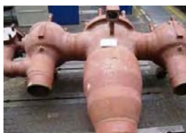
Obr. 10 Kontrola svaru ventilu
