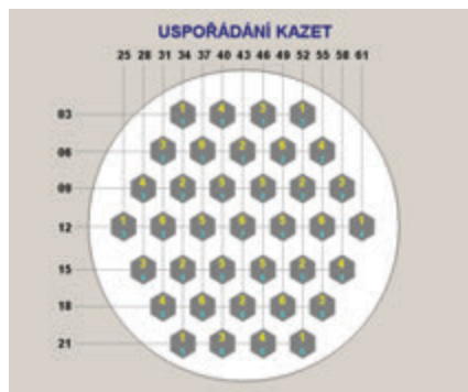
Obr. 1 – Uspořádání kazet HRK v reaktoru VVER 440 (žluté číslice označují skupinu kazet HRK, modré číslice označují pořadí pohonu ve skupině)
