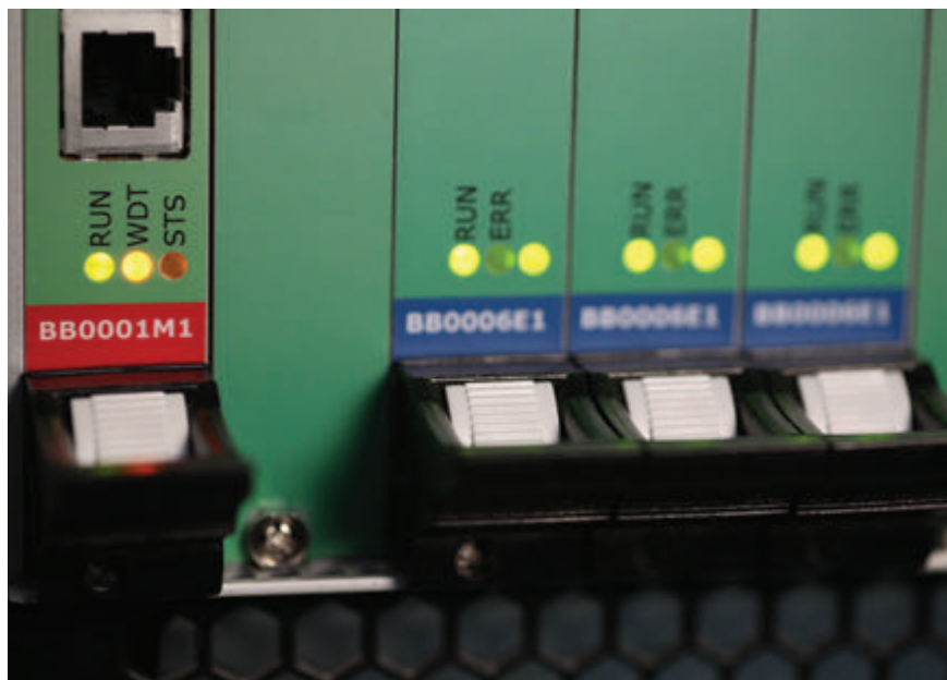
Procesní stanice SandRA Z200 s detailem na desku mikropočítače (základní uživatelsky programovatelná jednotka)
