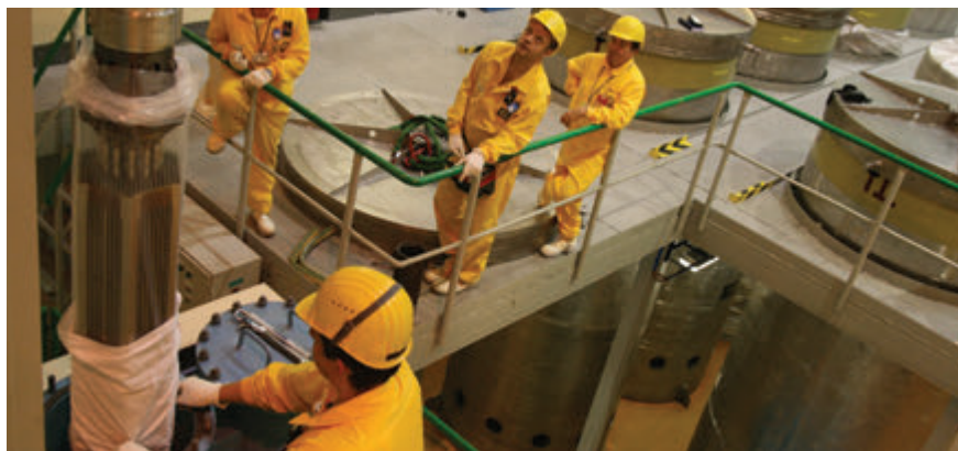
Manipulace s palivovými soubory ve skladu čerstvého jaderného paliva
