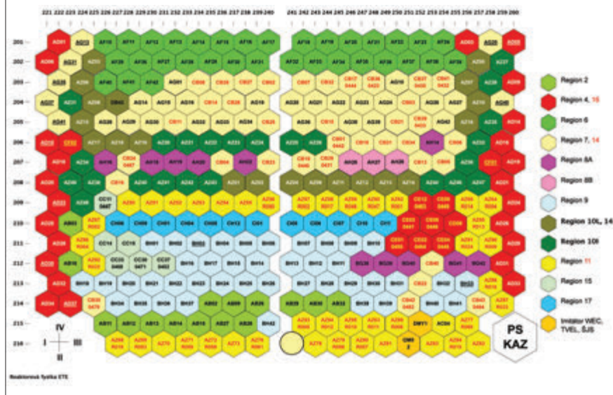
Příklad kartogramů jednoho z bazénů skladování vyhořelého paliva - před vyvezením aktivní zóny a po vyvezení aktivní zóny 1. bloku v roce 2012
