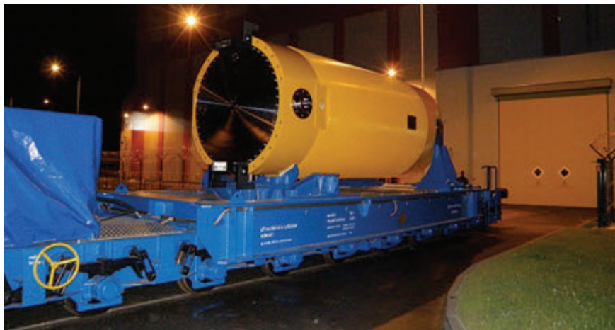
Převoz vyhořelého jaderného paliva do skladu vyhořelého paliva
