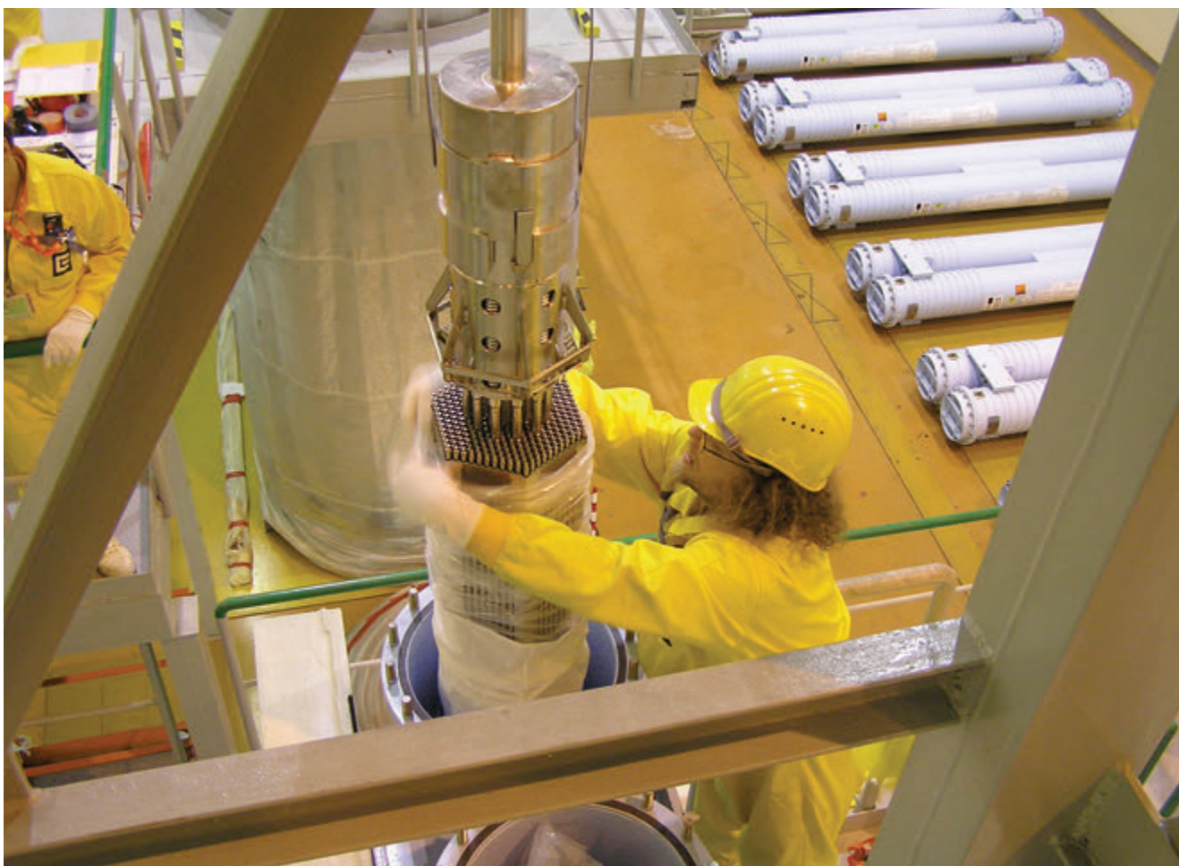
Manipulace s palivovými články v jaderné elektrárně Temelín – ilustrační foto
