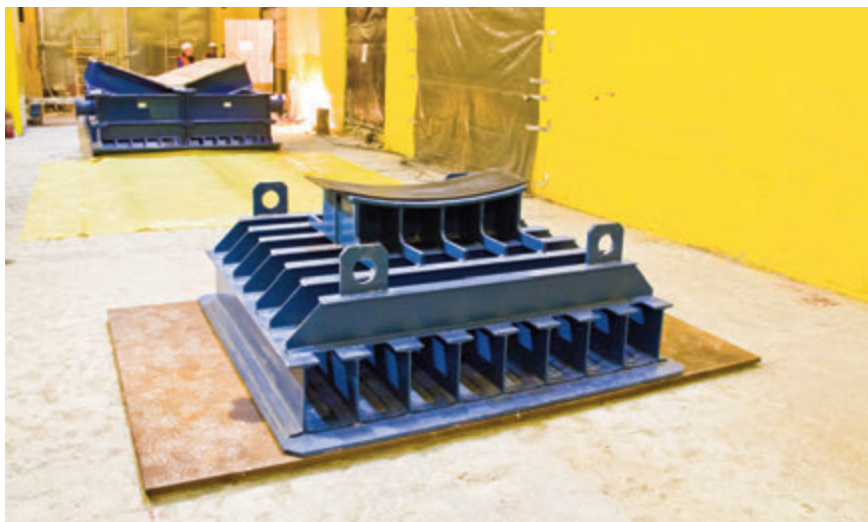
Obr. 8 – Ustavenie vztýčovacích prípravkov v zmysle schváleného postupu
