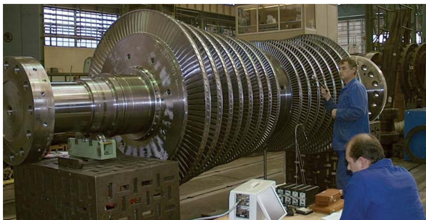
Modální analýza, celkový pohled na rotor - ilustrační foto
