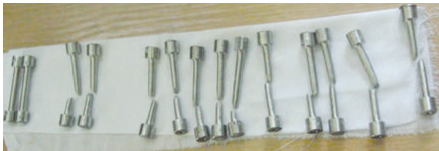
Sady tělísek pro zkoušku tahem při 20 a 350 °C (po zkoušce)
