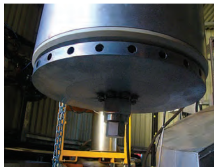
Titanový rozprašovací disk vápenného mléka
