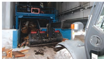
Materiál je do prostoru drtírný dopravován speciálními vozidly a do drtiče je podáván širokým pásovým dopravníkem.
