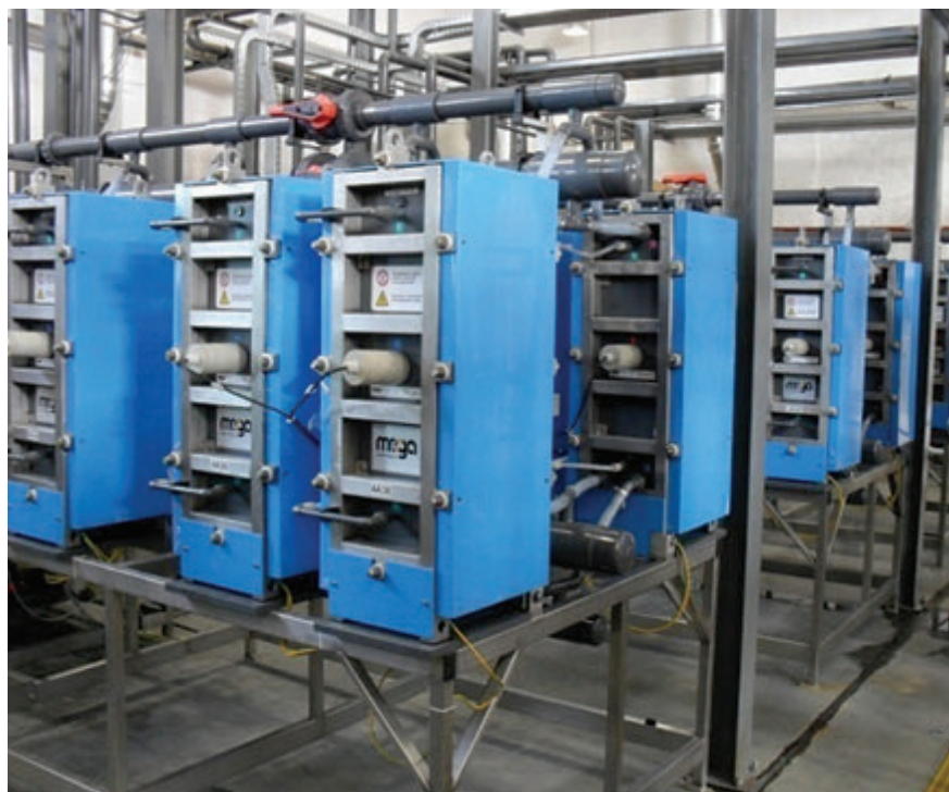
Obr. 2 – Elektrodeionizace 96 m 3 /hod. (Membrain s.r.o., Mega a.s.)
