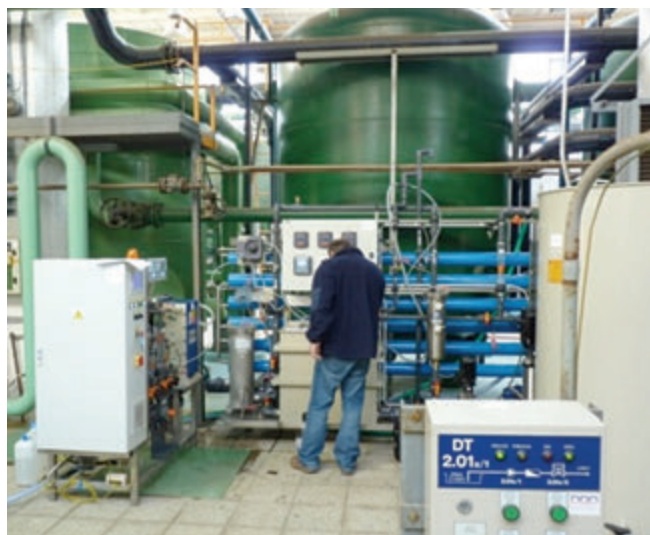
Obr. 1 – Vlevo - pilotní zařízení reverzní osmózy (RO) a elektrodeionizace firmy MemBrain v CHÚV Teplárny Liberec, vpravo - detail RO
