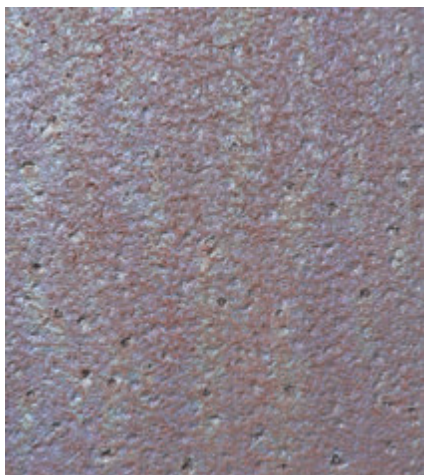
Obr. 3 – Typický vzhled patiny na nárožních stožáru
