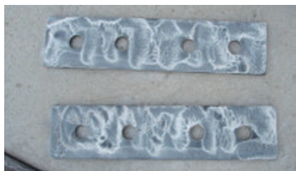
Obr. 9 – Nanášení teflonové vazelíny na příložky
