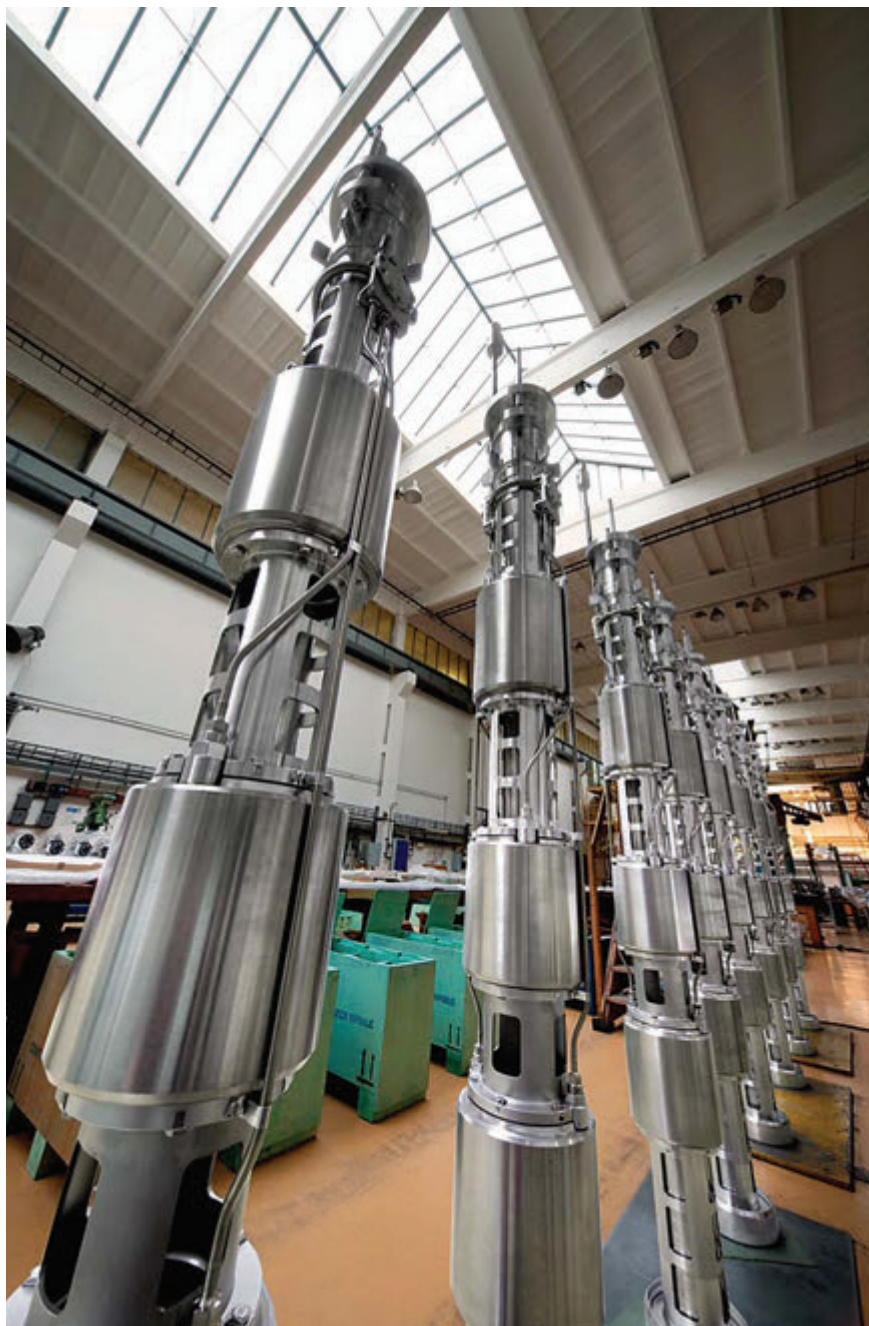
Bloky elektromagnetů pohonu řídicích tyčí reaktoru VVER – ilustrační foto
