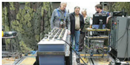
Snímky, které ukazují umístění zkušebního vzorku na testovacím standu v ose X - podélná, Z - příčná a Y - vertikální
