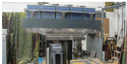
Snímky, které ukazují umístění zkušebního vzorku na testovacím standu v ose X - podélná, Z - příčná a Y - vertikální
