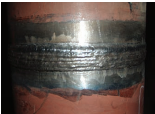
Krycí vrstva svaru komory DN 15 (ESAB)
