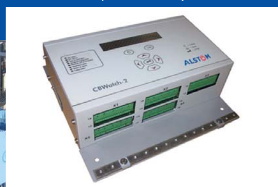
On-line monitoring zařízení VVN
