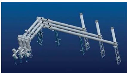
Obr. 5 – 3D model (nové transformátorové pole)
