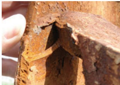
Sily namáhajúce diagonály spôsobili pozdĺžne trhanie materiálu
