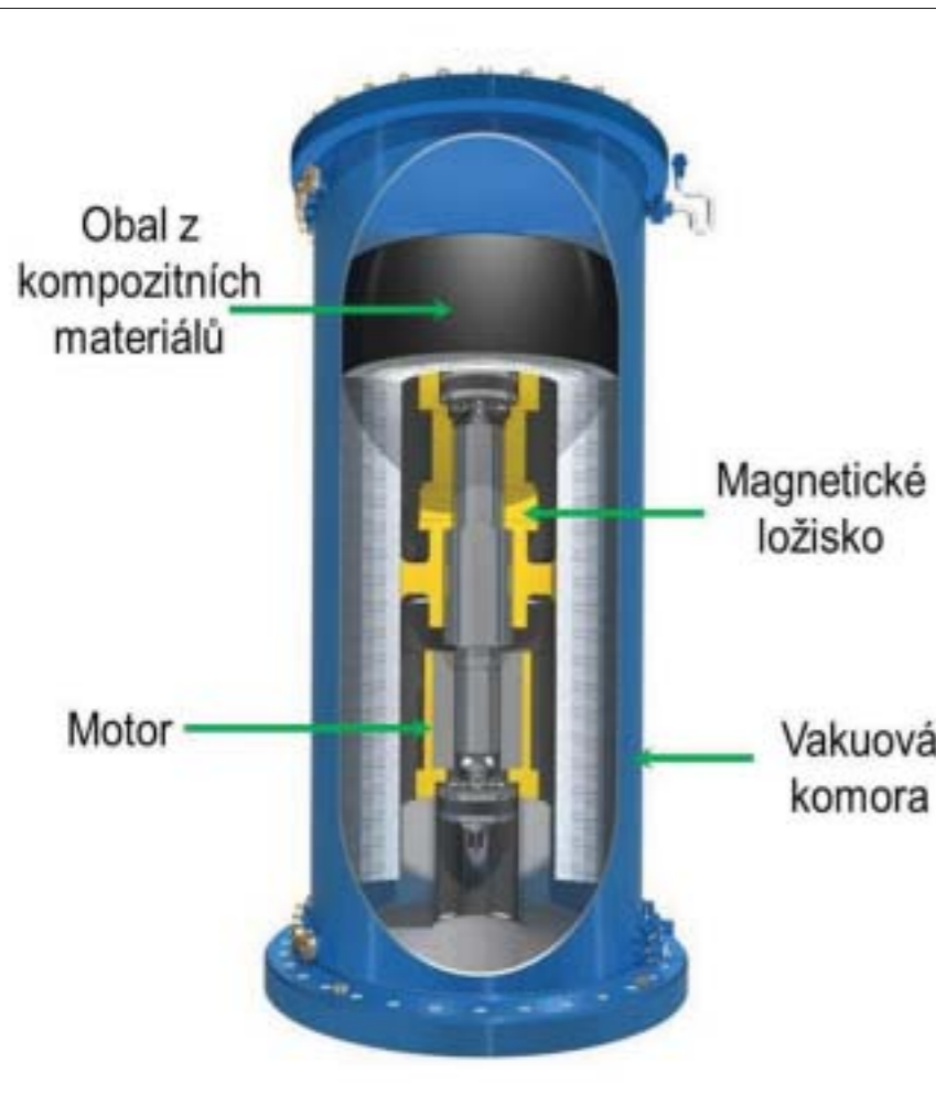
Schéma setrvačnicí firmy Beacon Power (Zdroj: www.beaconpower.com)
