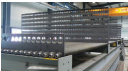
Výroba modulov pre horizontálne kotly na odpadné teplo
