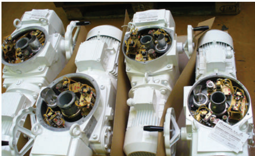
Servomotor MOA pro JE Mochovce – otočný víceotáčkový, typ: 52020 – 26, určení: mimo aktivní zónu, jmenovitý moment: 20 až 2 000 Nm, rychlost přestavení: 25 až 100 ot/min., napájecí napětí: 3 x 400 V
