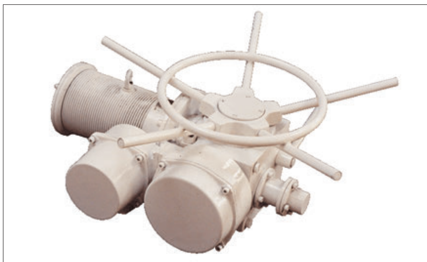
Servomotor MOA OC pro JE Mochovce – otočný víceotáčkový, typ: 52070 – 74, určení: aktivní zóna, jmenovitý moment: 20 až 630 Nm, rychlost přestavení: 16 až 100 ot/min, napájecí napětí: 3 x 400 V. Na základě požadavku Slovenských elektráren byly vyvinuty nové typy servomotorů, a to plně regulační s možností oddělené elektroniky pro řízení signálem 4 až 20mA s novým typem regulátoru ZP2RE6. Hmotnost servomotorů MOA OC se pohybuje v rozmezí 45 až 364 kg podle provedení a použitého materiálu (litina nebo hliník). Povrchová úprava se provádí dle přání zákazníka. Standardně se používá dvousložkový email do tloušťky nátěrů 240 mikronů.
