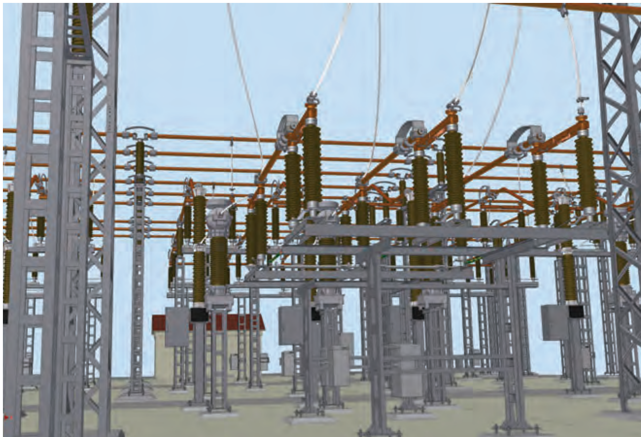
3D model technologie transformovny Kletné - Rozvodna 123 kV
