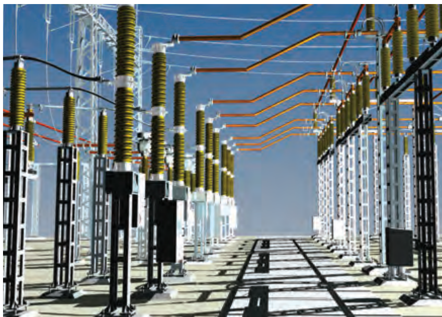
3D model - Rozvodna 110 kV Kletné - Pohled na vypínače 110 kV
