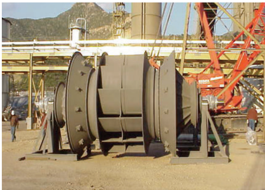
Rotor oboustranně sacího ventilátoru včetně regulačních ústrojí v ose rotace
