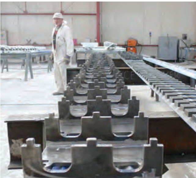
Sériová výroba delených kotiev už po záťažových testoch
