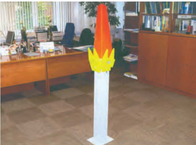
Dosadací uzol pre montáž stôžiarov vrtníkom umožňujúcim bezpečné spojenie dielov prvou stykovou doskou bez straty stability
