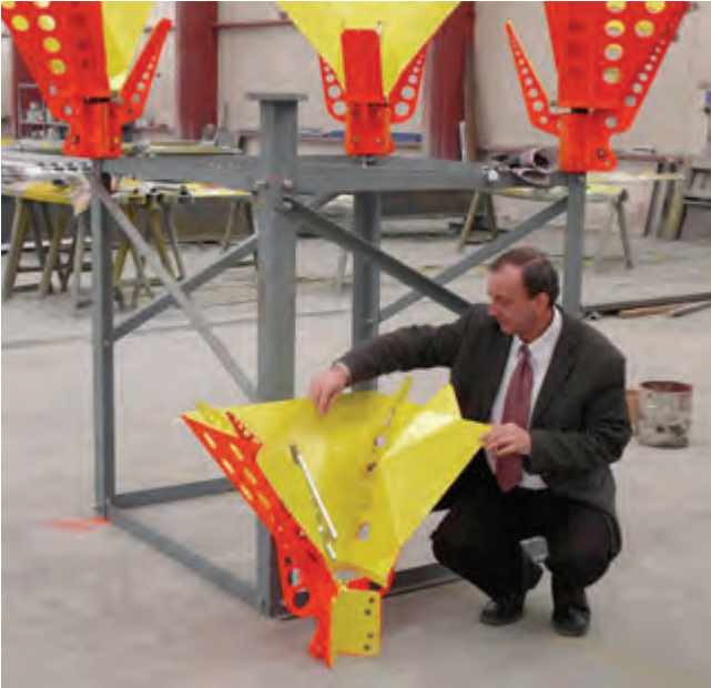
Prvotné testy overujúce geometriu a funkcie automatických stykových uzlov sa uskutočňovali na trénažeri s protikusom v závese žeriavu. Skutočná situácia vrtníka sa simulovala rozkývaním závesu
