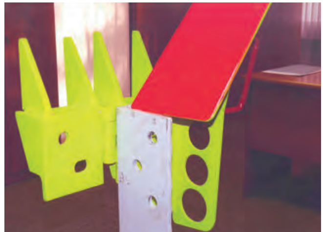
Dosadací uzol pre montáž stôžiarov vrtníkom umožňujúcim bezpečné spojenie dielov prvou stykovou doskou bez straty stability
