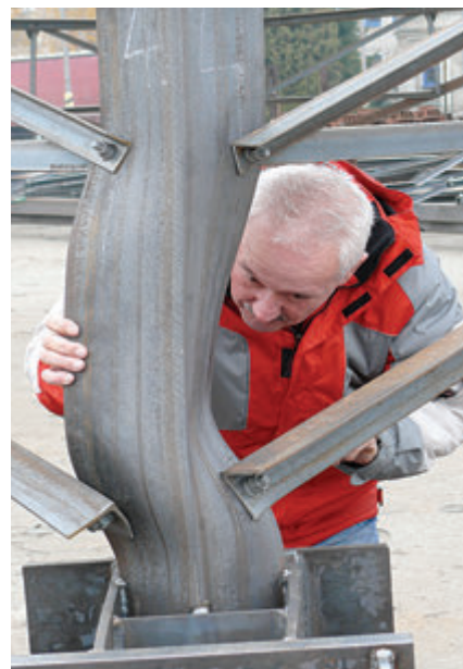
Asymetrická imperfekcia rohového uholníka po kolapse
