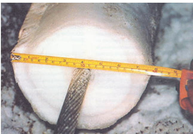
Ukážka takmer ideálne kruhového námrazového valca ľadu na vodiči s priemerom 200mm
