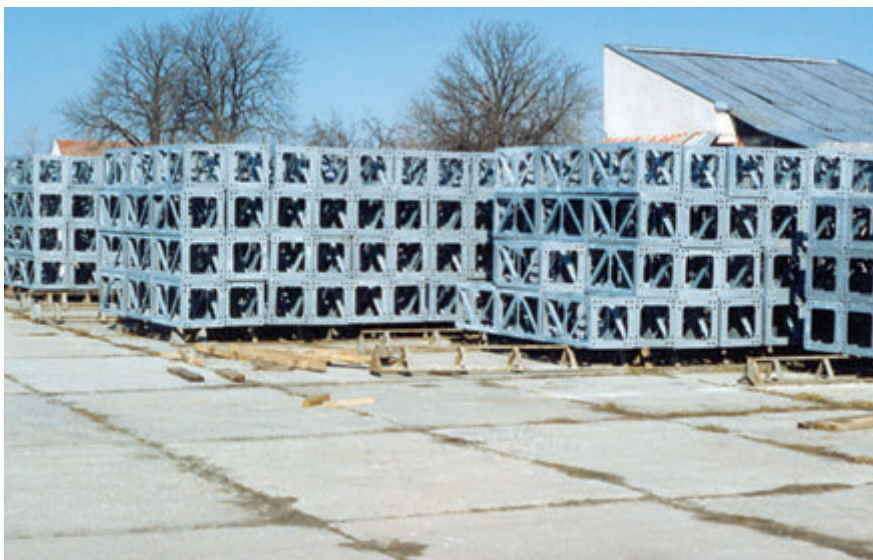
Úložisko jednotlivých dielov rôznych dĺžok potrebných k zostaveniu ľubovoľných stavebnicových stožiarov 110 kV, 220 kV a 400 kV
