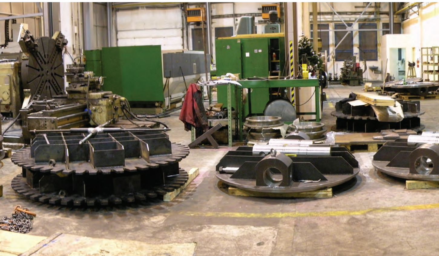
Polotovary pro výrobu klapky DN1800
