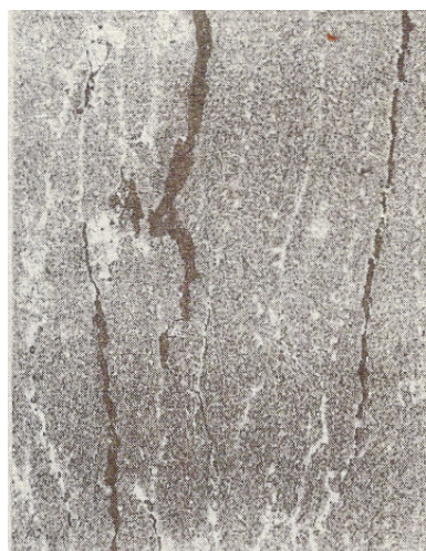
Charakteristický tvar krystalizační trhliny ve SK (200x)
