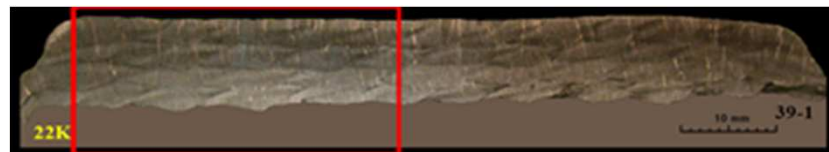
Makrostruktura celého návaru R39.1 (zv. 2x) - BÖHLER CN 23/12 PW-FD + BÖHLER SAS 2 PW-FD (stav po svaření)
