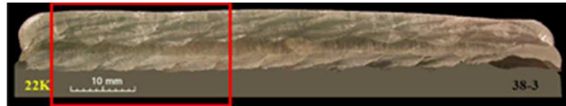
Makrostruktura celého návaru R38.3 (zv. 2x) - BÖHLER NIBAS 70/20 Mn-FD + BÖHLER EAS 2 PW-FD (stav po SŽ 450°C/500 hod)
