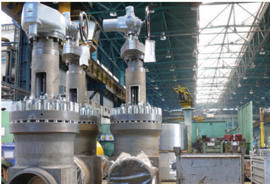
Odkoušené armatury před provedením konečné povrchové úpravy
