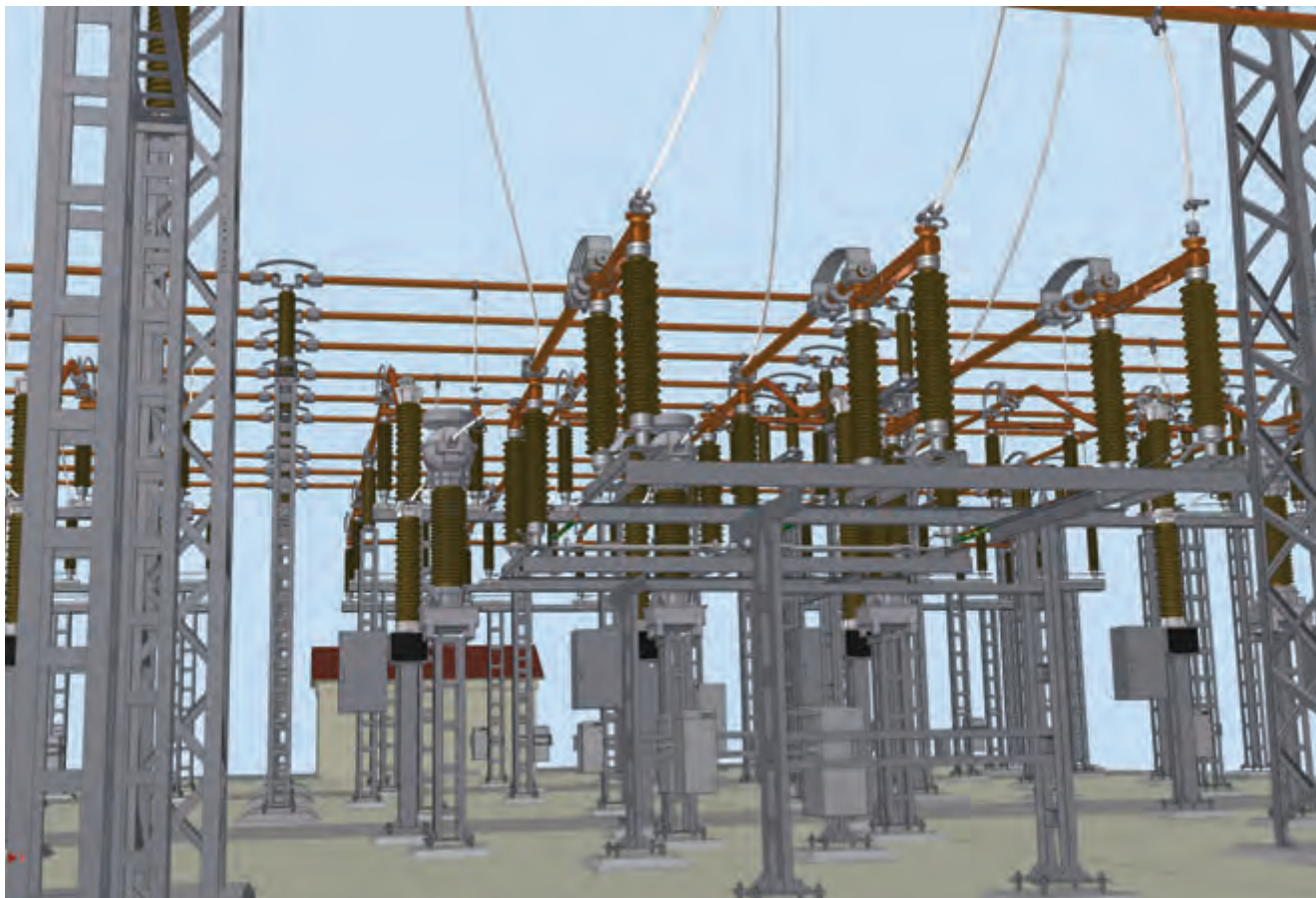
3D model technologie transformovny Kletně - Rozvodna 123 kV
