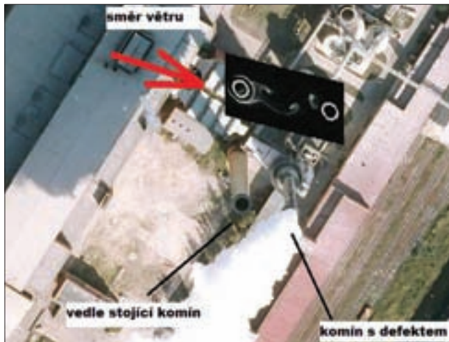
Obr. 11 – Pohled shora se schématickým vyznačením obtékání vzduchem
