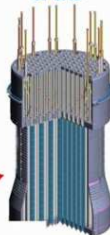
Blok ochranných trub
