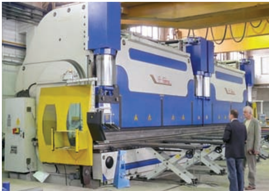
Elektronicky spriahnutý 12 000 mm dlhý ohraňovací lis pre výrobu ohraňovaných stožiarov
