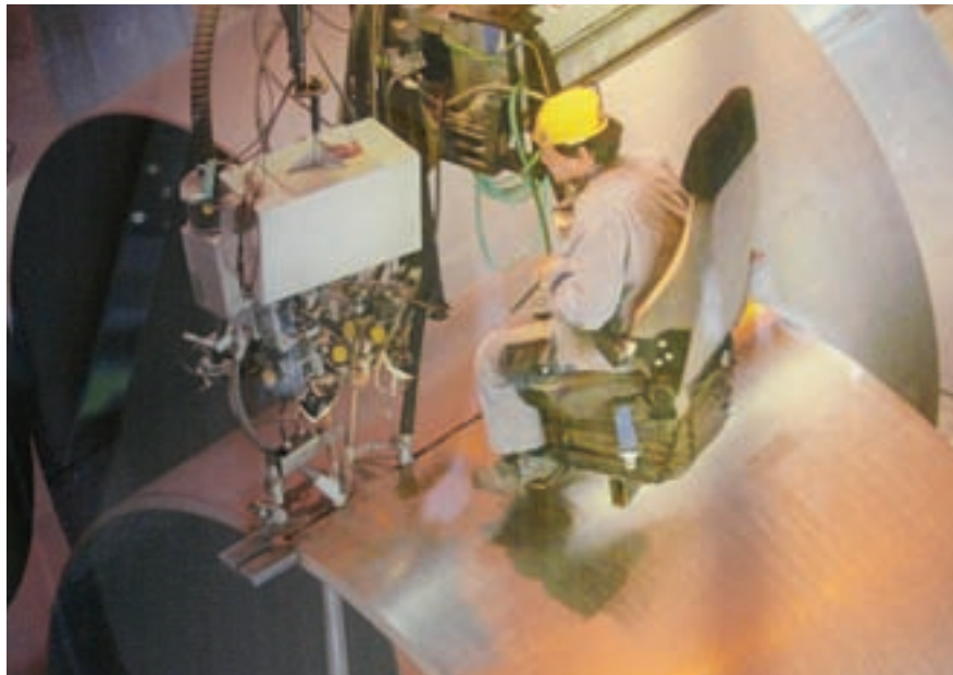
Výroba lubu pre driek zakružovaného stožiaru počas pozdĺžneho zvaru metódou pod tavidlom
