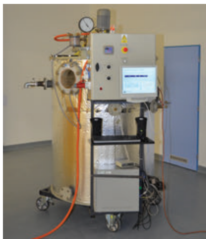
Experimentální fermentor o užitném objemu až 1 000 litrů, umožňující ověřovat procesy probíhající na bioplynových stanicích
