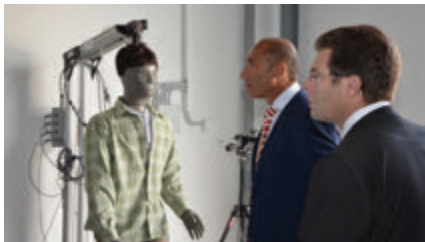
Tepelný manekýn se používá k ohodnocení komfortu osob ve vnitřním a venkovním prostředí
