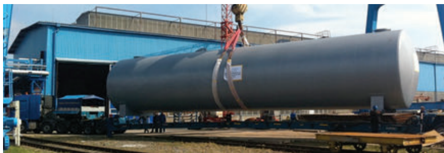
Limitní hodnoty vyráběných produktů jsou omezeny hmotností 50 tun, průměru 6 a délkou 30 metrů
