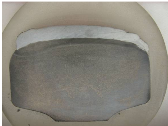
Obr. 2a Makroštruktúra návaru bez použitia predhrevu, vzorka A1
