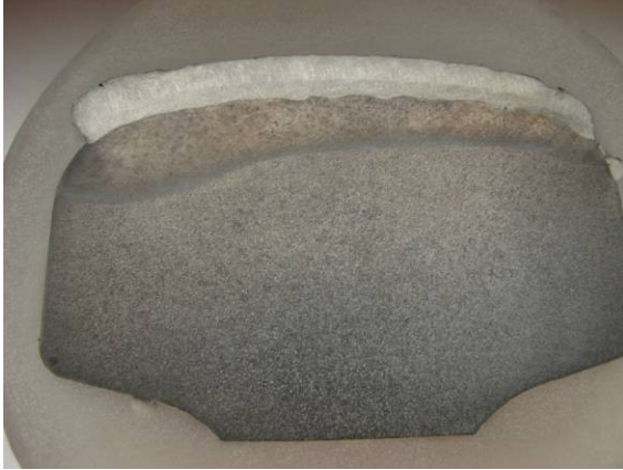
Obr. 3a Makroštruktúra návaru vzorky A2 pri predhreve 250°C
