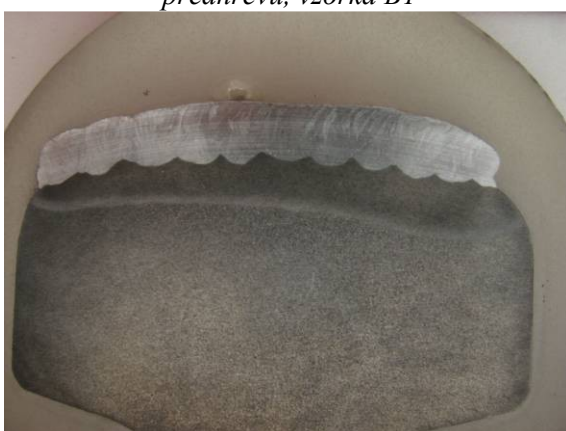
Obr. 6a Makroštruktúra návaru vzorka B2 s predhrevom 250°C
