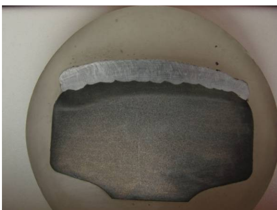
Obr. 7a Makroštruktúra návaru s použitím predhrevu 350°C, vzorka B3
