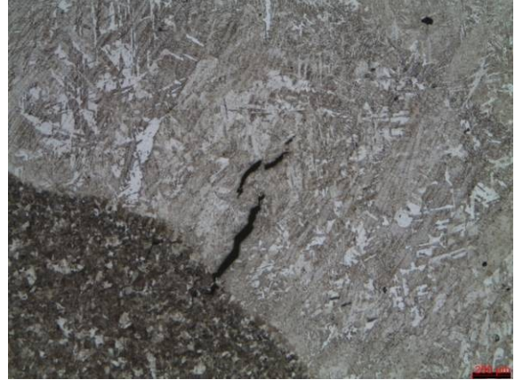
Obr. 3b Detail hranice natavenia vzorky A2 s výskytom kryštalizačných trhlín
