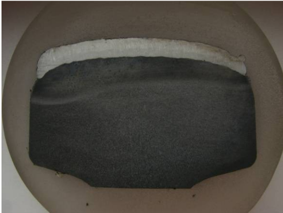
Obr. 4a Makroštruktúra návaru vzorky A3 pri predhreve 350°C
