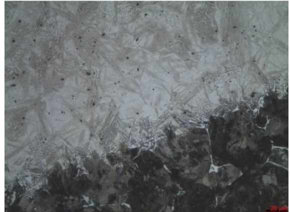
Obr. 4b Detail hranice natavenia vzorky A3 v prechode do ZM koľajnice
