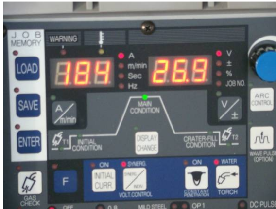
Obr. 1 Príklad vyhotovenia návaru drôtom OK Tubrodur 15.43 na zariadení AUTOWELD 5000 s použitím predhrevu 350°C
