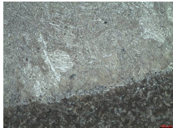
Obr. 2b Detail hranice natavenia ZM koľajnice vzorky A1
