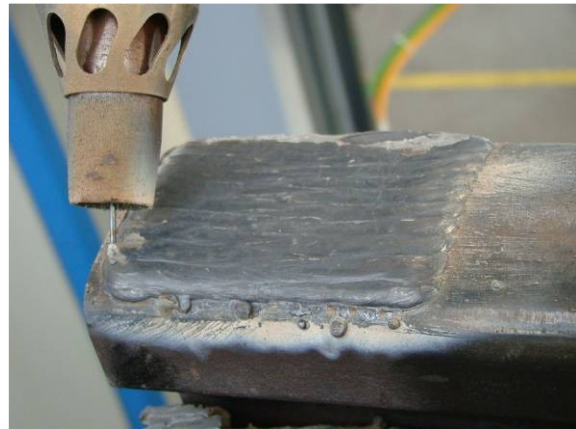
Obr. 1 Príklad vyhotovenia návaru drôtom OK Tubrodur 15.43 na zariadení AUTOWELD 5000 s použitím predhrevu 350°C
