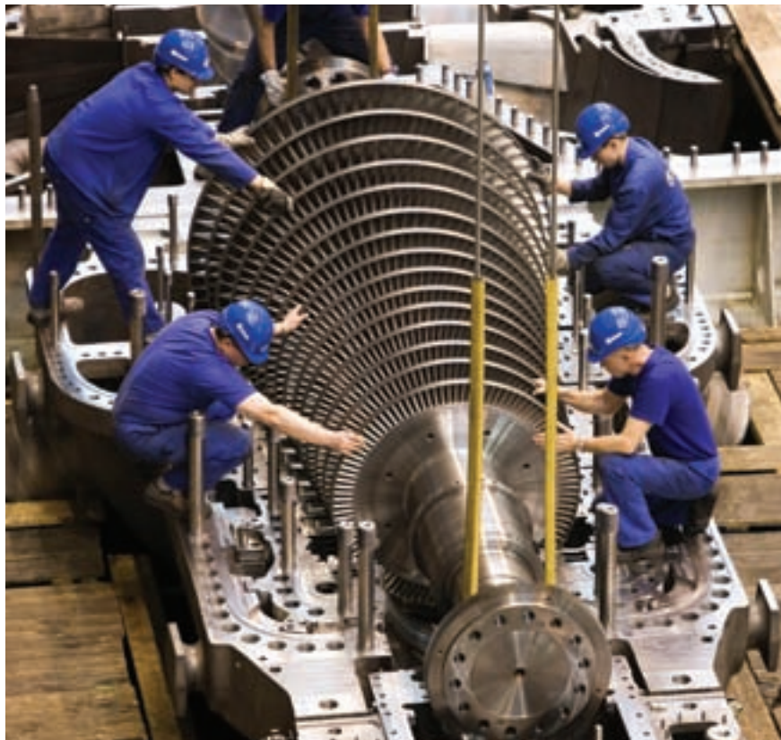
Kontrolní montáž středotlakového dílu ve výrobním závodě
