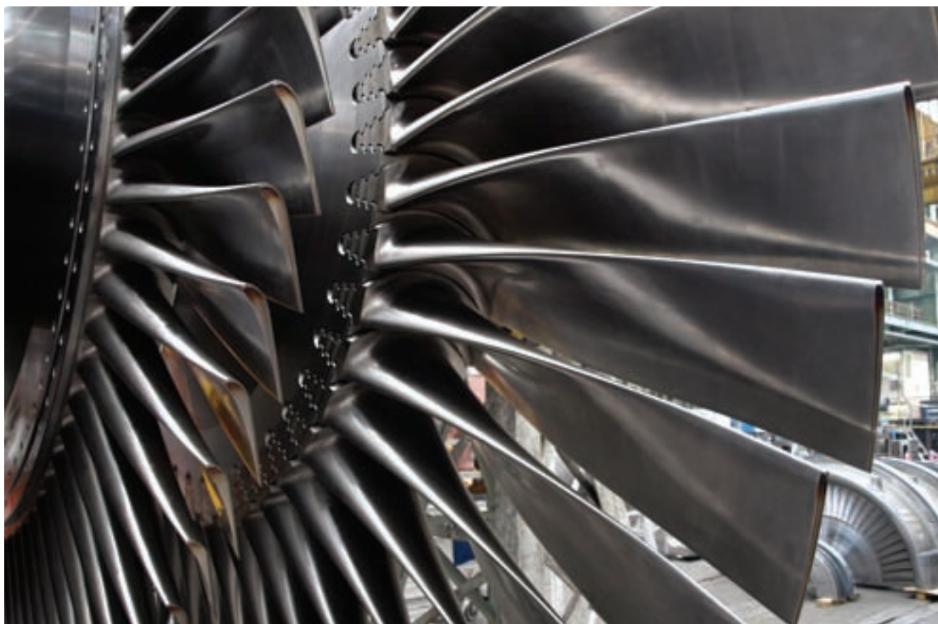
3D lopatkování - koncový nízkotlakový stupeň
