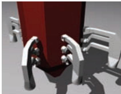
3D pohled na práškovody a hořáky
