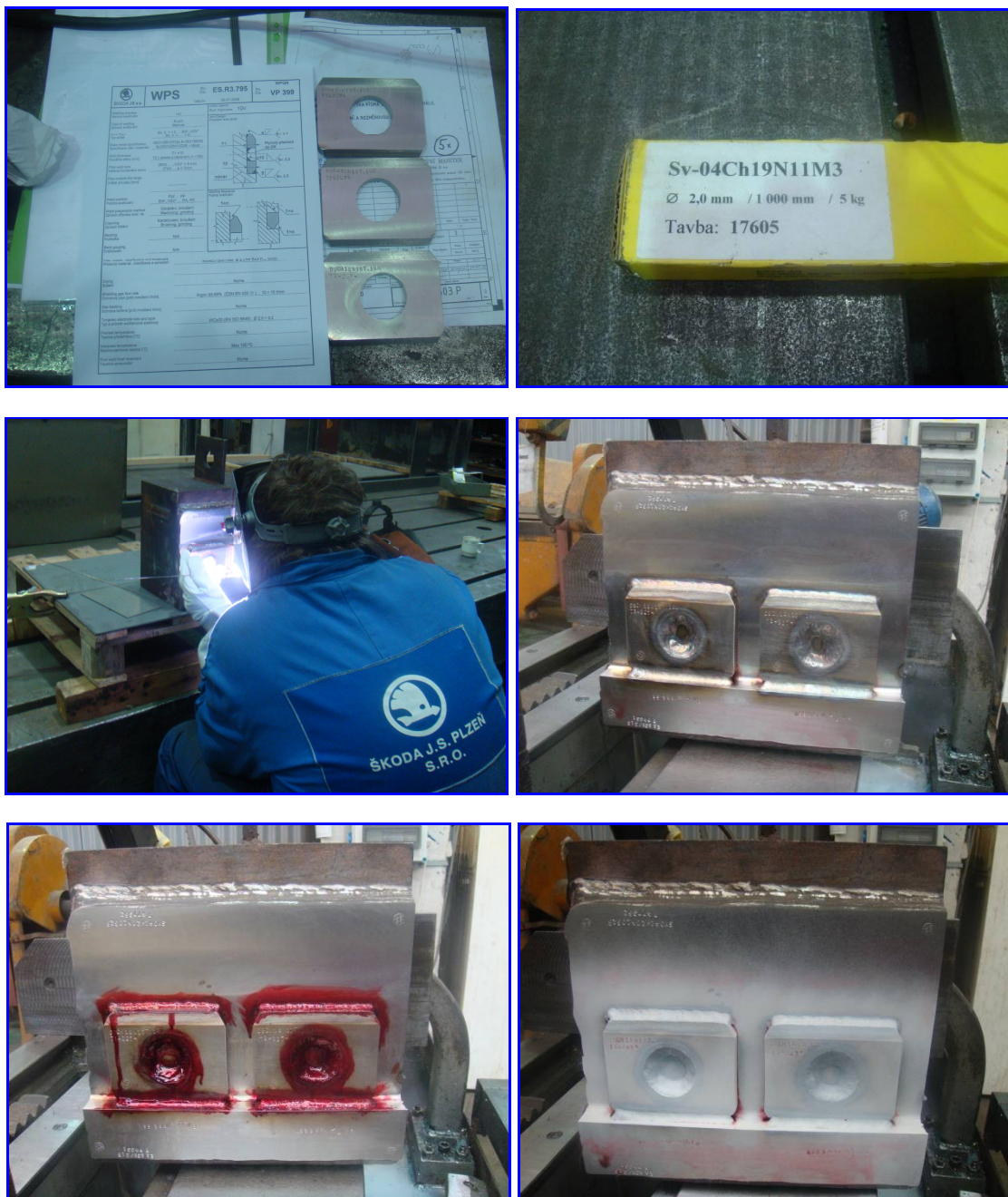
Obr. 6 Kontrolní svarový spoj [2]
