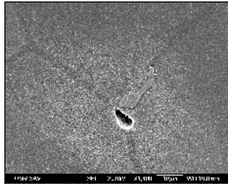
b) NbX na hranici zrna, vzorka B8 (650°C/170MPa/2318h).
