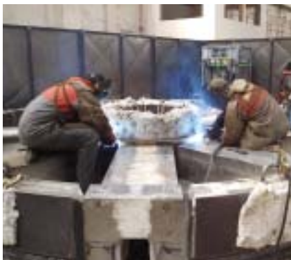
Obr. 7 Přivařování náboje v vrchlíku lícní desky
