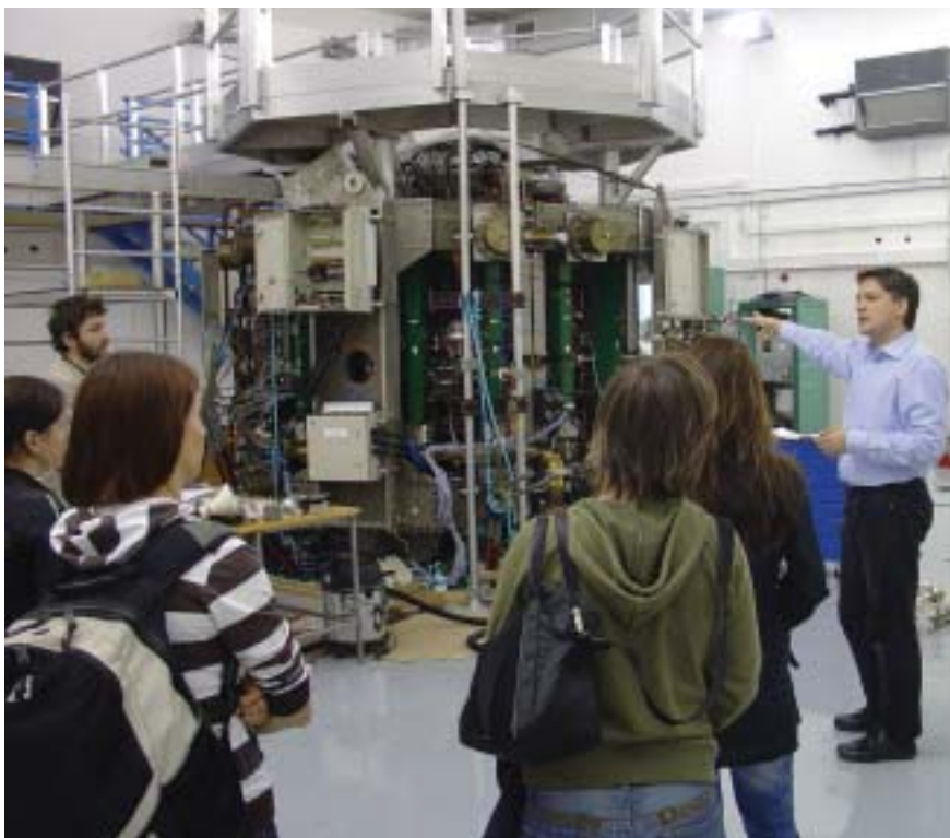
Moderní tokamak COMPASS původem z anglického Culham Science Centre v Ústavu fyziky plazmatu AV ČR. (Foto: Milan Řípa)
