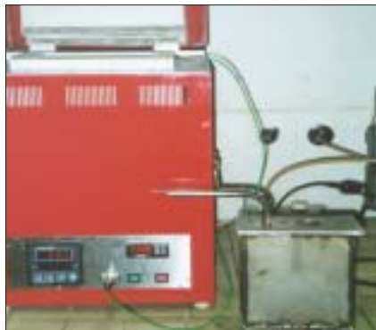
Obr. 1 - Laboratorní pyrolýzní pec s retortou
