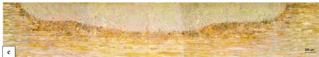
Obr. 2: Makrostruktura průvaru duplexní korozivdorné oceli LDX 2101
