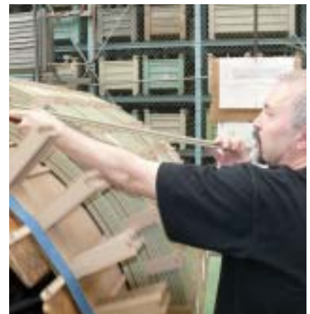
Navíjení fáze pro trafo 300 MVA
