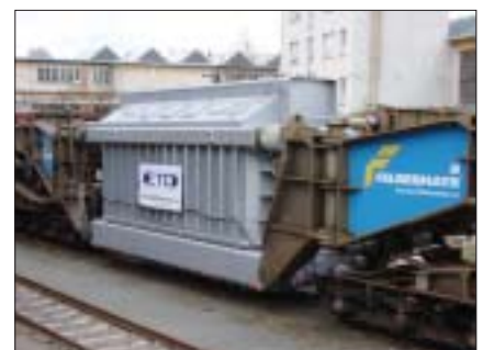
Trafo 300 MVA připravené k transportu do JE Dukovany
