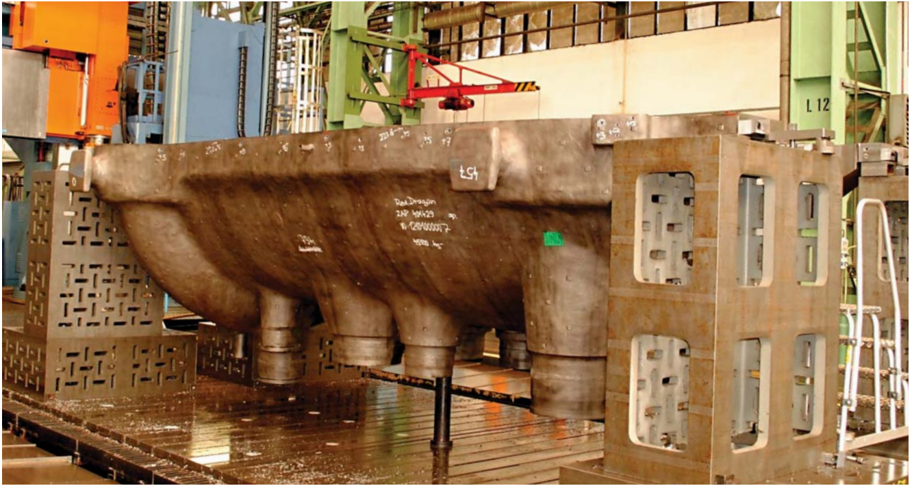
Obrábění turbínového tělesa
