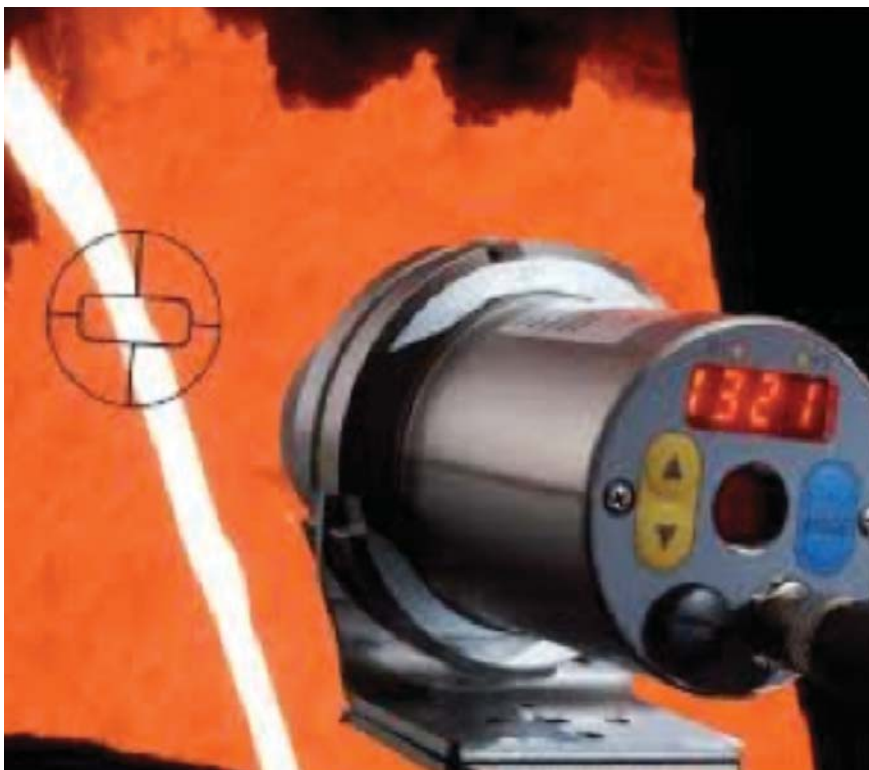
Obr. 18 – Obdélníkový spot je při měření teploty tekutého kovu užitečný, neboť zajišťuje odolnost systému vůči posunu v jedné ose
