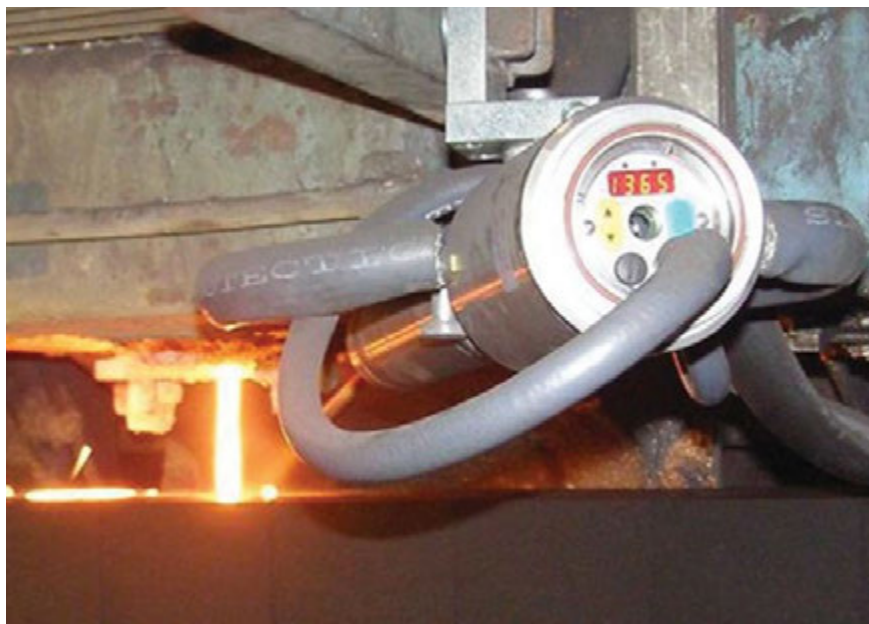
Obr. 19 – Měření teploty tekutého kovu. Pyrometr měří teplotu tekutého kovu před nalitím do formy. Přístroj je chráněn odolným, vzduchem chlazeným krytem
