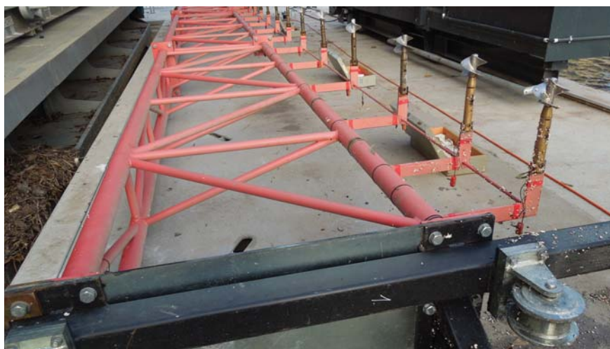
Rám s hydrometrickými vrtulami po vytažení z měrného profilu
