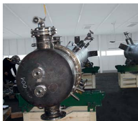
☒ Ve výrobních halách je možné spatřit i velice atypické výměníky tepla
