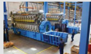
Montážní linka Bergen Engines s dvěma 20válcovými motory B35:40
