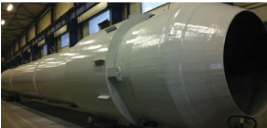
Komínová vložka DN 2200 v nosném ocelovém potrubí
