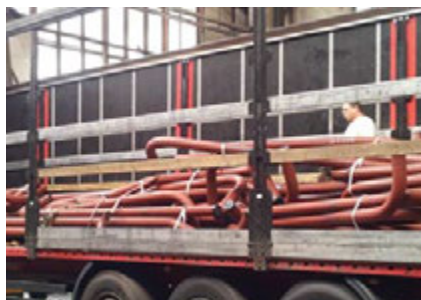
Příprava na přepravu převáděcího potrubí
