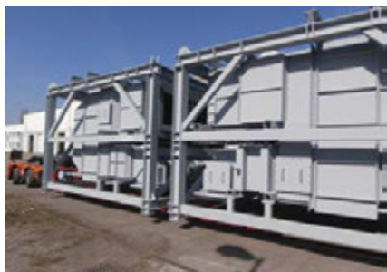
Bloky ekonomizérů kotle K5
