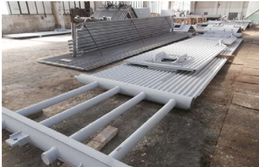
Membránové stěny kotle K5 pro teplárnu v Plané
